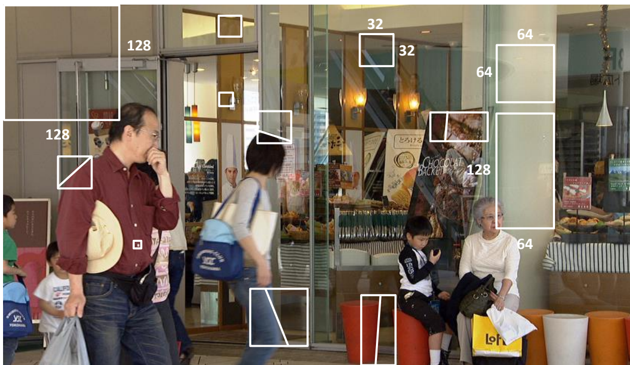
Rysunek 4-87. Rozważane w VVC rodzaje i rozmiary bloków. Wachlarz dostępnych rozmiarów bloków będzie znacznie większy niż w przypadku wcześniejszych koderów.
