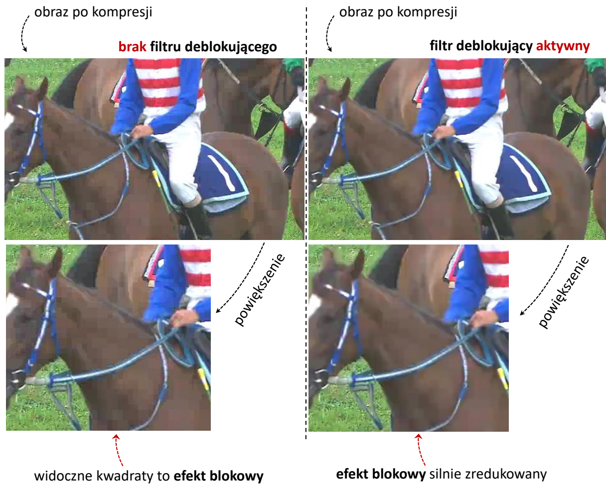
Rysunek 4-35. Ilustracja rezultatu działania filtracji deblokującej na obrazie po stratnej kompresji. Przykłady dla obrazu sekwencji testowej „RaceHorses”. Obrazy zostały przygotowane z użyciem modelowego oprogramowania JM 18.5 kodera wizyjnego MPEG-4 AVC/H.264 [AVCSof].
