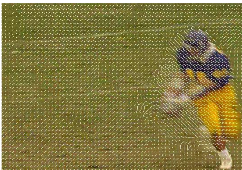
wektory ruchu – metoda przepływu optycznego
