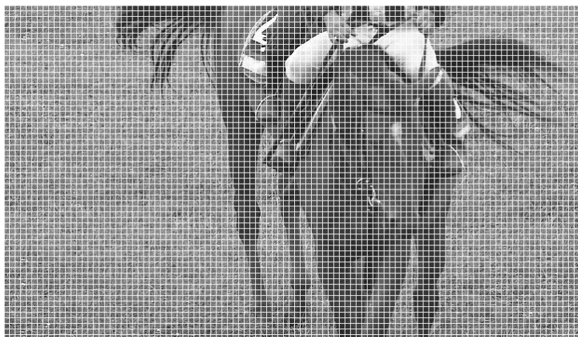
Rysunek 4-16. Obraz o rozdzielczości przestrzennej 832x480 z nałożoną siatką bloków o rozmiarze 8x8 próbek. Niezależnie, w kolejnych blokach 8x8 jest realizowana idea kompresji transformatowej obrazu.
