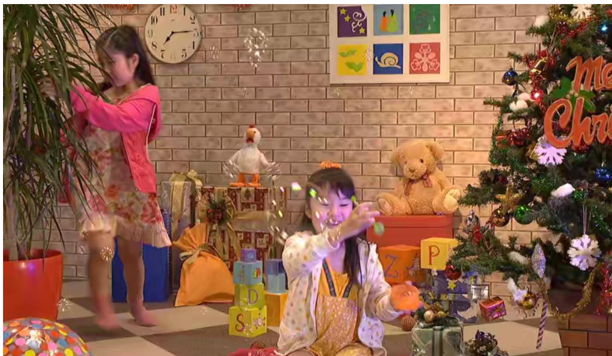
Rysunek 4-42. Zdekodowany obraz po wcześniejszej kompresji. Stopień kompresji wynosi 28,73 . W niektórych fragmentach obrazu zaczynają być widoczne błędy, np. rozmycie szumu, który przed kompresją był widoczny na podłodze (uwaga: szum ten był elementem treści oryginalnego obrazu).
