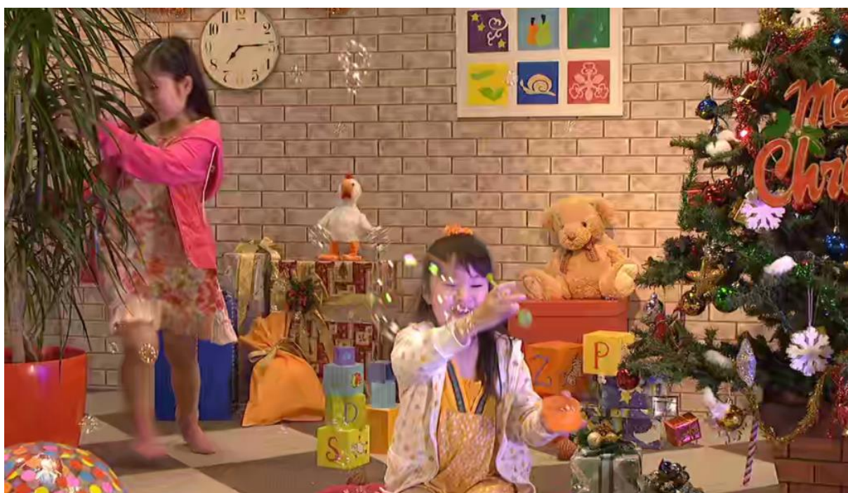
Rysunek 4-43. Zdekodowany obraz po wcześniejszej kompresji. Stopień kompresji wynosi 39,98 . W niektórych fragmentach obrazu zaczynają być widoczne błędy, np. rozmycie szumu, który przed kompresją był widoczny na podłodze.
